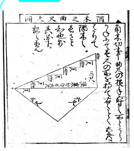
※①隅木を切って、※②曲尺の表面の横の手の五寸の所と裏面の一尺の所を持って、図のように六回測って隅木の長さが分かった。
